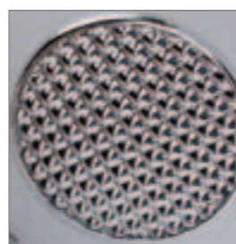
Вторичный отражатель с микрозеркалами
